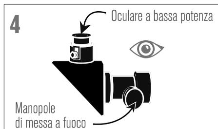
4 Osservare attraverso l'oculare da 20mm del telescopio. Ruotare con cura le manopole di messa a fuoco per regolare la nitidezza dell'immagine.
