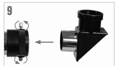
9 Localice la diagonal de imagen recta y saque las tapas de plástico. Introduzca el cañón de la diagonal en el enfoque y asegúrelo en posición apretando los tornillos.
