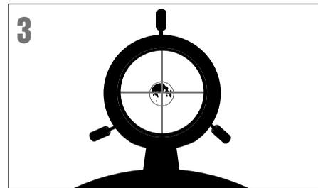
3 Regardez dans le chercheur et localisez le réticule du viseur. Continuez à orienter le télescope jusqu'à ce que le viseur soit superposé sur la Lune.
