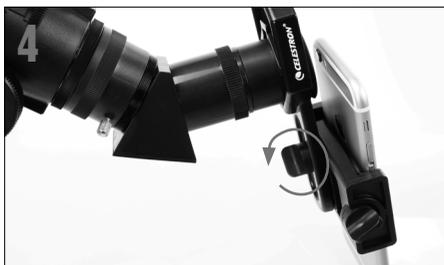
4 Lösen Sie den Knopf auf der Unterseite des Adapters, mit dem die Telefonklammer an der Okularklemme befestigt ist. Schieben Sie die Telefonklammer nach oben und unten und drehen Sie sie nach links und rechts, bis Ihre Kamera durch das Okular des Teleskops nach unten schaut. Ziehen Sie den Knopf auf der Unterseite des Adapters fest, um ihn zu sichern.
