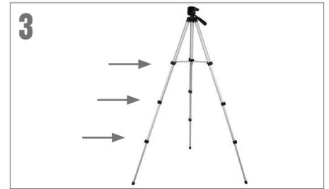
Ziehen Sie die Beine des Stativs heraus, indem Sie die drei Stativverriegelungshebel an jedem Bein lösen. Ziehen Sie jeden Beinabschnitt ganz heraus und drücken Sie den Hebel an jeder Verriegelung nach unten, um ihn zu sichern.
