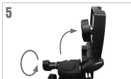
5 Allentare la manopola sul lato della piattaforma di montaggio della testa del treppiedi e ruotare la piattaforma di 90° in modo che stia verticalmente.
