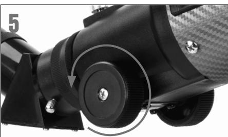
Utilisez le système de mise au point du télescope pour mettre la caméra au point. Capturez l'image via l'application d'appareil photo.
