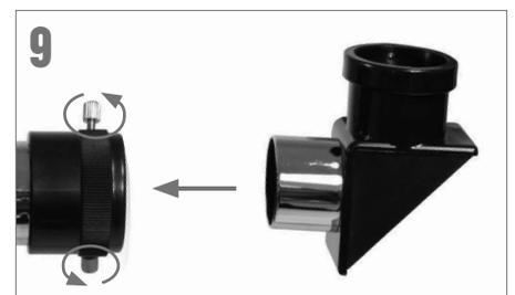
Nehmen Sie den Zenitspiegel für aufrechtes Bild und entfernen Sie die Kunststoffabdeckungen. Setzen Sie die Steckhülse des Zenitspiegels in den Fokussierer ein und sichern Sie sie durch Anziehen der Stellschrauben.
