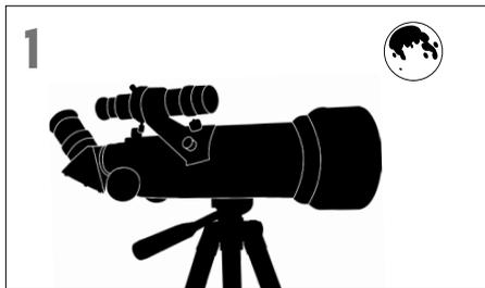
1 Lorsque la Lune est visible dans le ciel, installez votre télescope avec l'oculaire de 20 mm.
