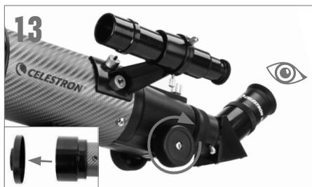
13 Rimuovere i cappucci dell'obiettivo dalla parte anteriore del telescopio. Per osservare, guardare attraverso l'oculare come mostrato. Mettere a fuoco l'immagine ruotando le manopole al di sotto del focalizzatore.
