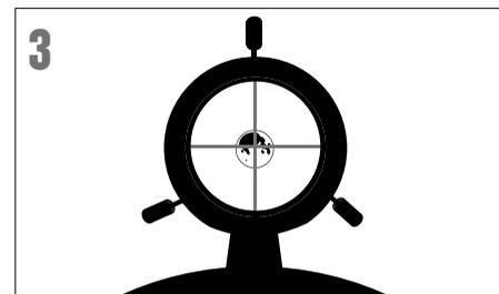
**3** Schauen Sie durch das Sucherfernrohr und suchen Sie das Fadenkreuz. Schwenken Sie das Teleskop weiter, bis das Fadenkreuz über dem Mond erscheint.
