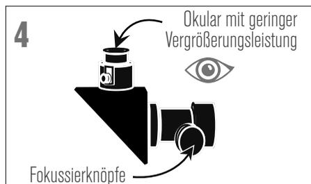
**4** Schauen Sie durch das 20-mm-Okular des Teleskops. Drehen Sie die Fokussierknöpfe langsam, um das Bild scharfzustellen.
