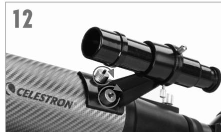
12 Trouvez le chercheur dans la boîte et retirez les capuchons de plastique de l'avant et de l'arrière de la lentille. Orientez le chercheur de manière à ce que l'objectif plus grand soit orienté vers l'avant du tube, comme illustré. Positionnez le chercheur sur les supports du tube et remettez les écrous striés en place pour le fixer.
