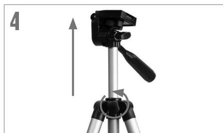
4 Per estendere il montante centrale del treppiedi, ruotare la manopola di blocco in senso antiorario, sollevare la testa del treppiedi fino all'altezza desiderata e ruotare la manopola di blocco in senso orario per assicurarla.
