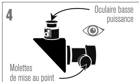
4 Regardez dans l'oculaire de 20 mm dans le télescope. Faites tourner doucement la molette de mise au point pour ajuster le netteté de l'image.
