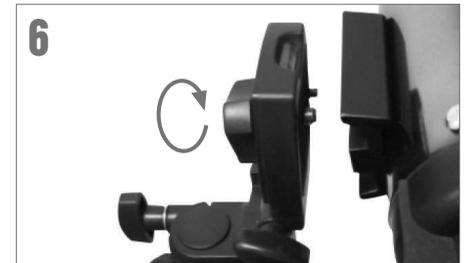
Positionnez le boulon fileté de la plateforme de la monture sur le pas de vis situé sur le dessous du tube du télescope, et vissez-les ensemble. Ne serrez pas excessivement. La connexion doit être ferme, mais doit permettre le mouvement.
