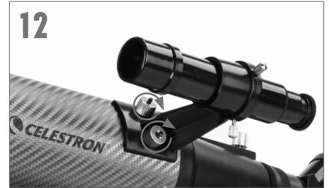
Nehmen Sie das Sucherfernrohr und entfernen Sie die Plastikklappen von den Linsen. Richten Sie das Sucherfernrohr so aus, dass die größere Linse zur Vorderseite des Tubus zeigt, wie dargestellt. Platzieren Sie das Sucherfernrohr über den Stützen des Tubus und setzen Sie die Rändelmuttern wieder ein, um es zu sichern.
