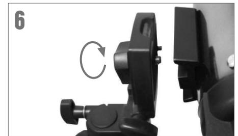
6 Haga coincidir el perno estriado de la plataforma de montaje con el agujero de la parte inferior del tubo del telescopio y enrósquelo. No lo apriete en exceso. Debería quedar ajustado pero no apretado.
