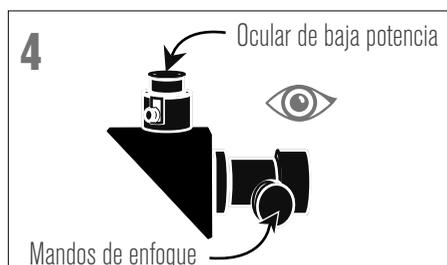
Mire por el ocular de 20mm del telescopio. Gire suavemente los mandos de enfoque para ajustar la definición de la imagen.
